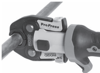
Figure 7 – Engagement de mâchoires à ciseaux autour du raccord
