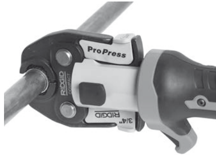
Figur 7 - Plassering av pressbakkene rundt presskoblingen
