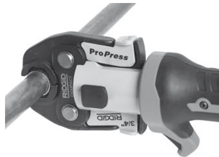
Figur 7 – Placering af saksekæber omkring fitting
