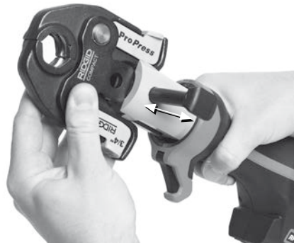
Figura 5 – Perno di montaggio dell'accessorio
