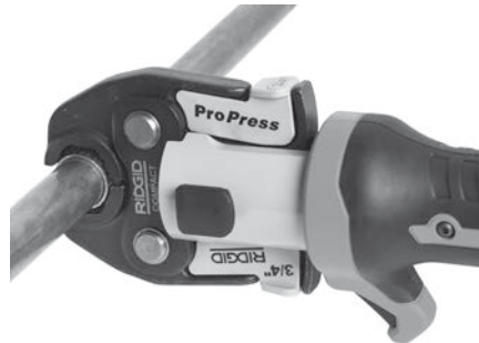
Kuva 7 – Saksityyppisten leukojen asettaminen liittimen ympärille
