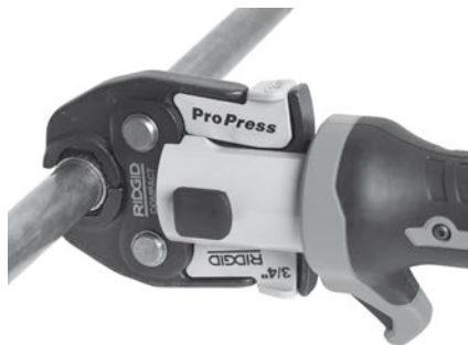
Rys. 7 – Umieszczanie szczęk nożowych wokół okucia
