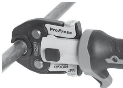
Figura 7 – Collocamento di ganasce di stile a forbice intorno al raccordo
