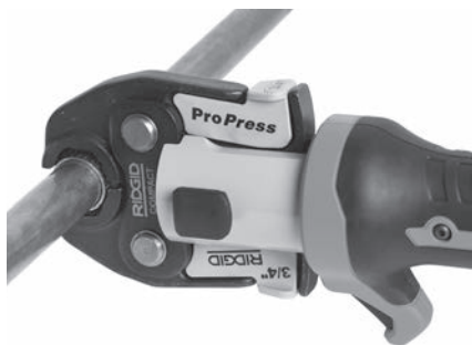
Figura 7 – Colocación de las mordazas para que encierren el acoplamiento
