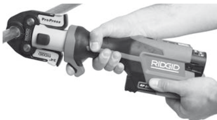
Figur 9 - Pressing av presskoblingen
