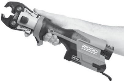
Bild 6 – Öppning av käken med en hand
