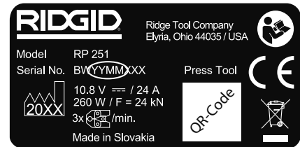
Εικόνα 2 - Αριθμός σειράς μηχανήματος - Τα κυκλωμένα ψηφία επισημαίνουν το έτος και τον μήνα κατασκευής. (YY = έτος, MM = μήνας, )
