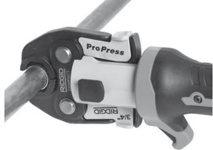
Figuur 7 – Aanbrengen van schaarbekken rond fitting
