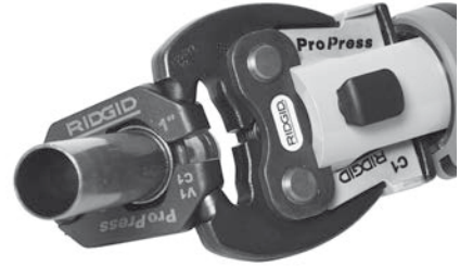
Şekil 10 – Aktüatörün Pres Halkasına Takılması
