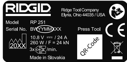
Figura 2 – Numero di serie della macchina - I numeri cerchiati indicano l'anno e il mese di produzione. (YY = anno, MM = mese,)
