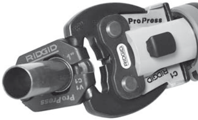
Figur 10 – Fastgørelse af aktuator på pressering
