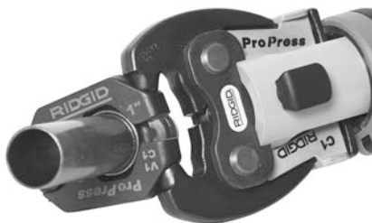
Фигура 10 – Прикачане на задвижващия механизъм към пръстена за пресоване
