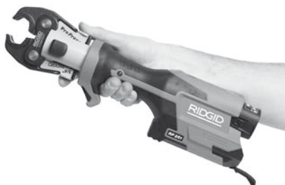
Figura 6 – Apertura della ganaschia con una mano
