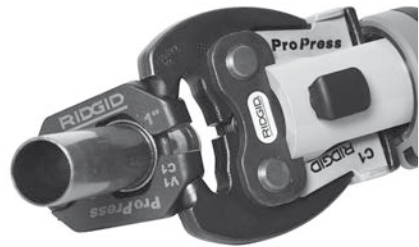
Figura 10 – Prender o Atuador no Anel de Prensagem
