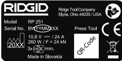
Abbildung 2 - Seriennummer der Maschine - Einkreiserte Ziffern geben das Jahr und den Monat der Herstellung an. (YY = Jahr, MM = Monat, )
