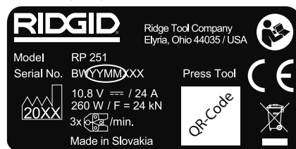
2. ábra – A gép sorozatszám - A bekariázott számjegyek jelölik a gyártás hónapját és évét. (YY = év, MM = hónap, )
