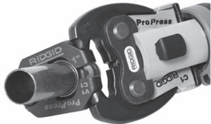
Figura 10 – Instalación del accionador en el aro de compresión
