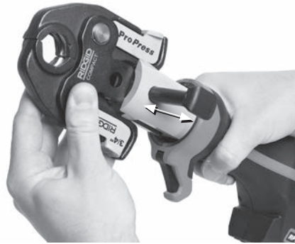
Figura 5 – Pasador de montaje de accesorios
