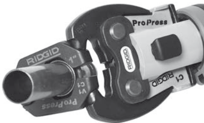
Abbildung 10 – Ansetzen des Stellantriebs am Pressring
