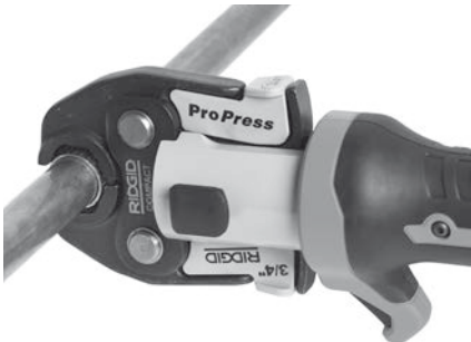
7. ábra – A szerelvény körülzárása ollós pófákkal
