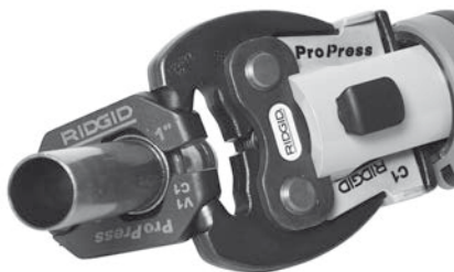
Slika 10 – Pričvršćivanje aktuatora na prsten za prešanje
