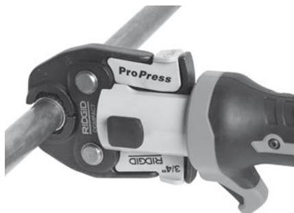
Рис. 7 – Установка пресс-клещей ножничного типа вокруг фитинга
