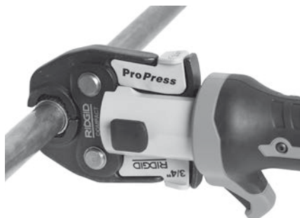
Figura 7 – Colocar os mordentes estilo tesoura à volta do engaste
