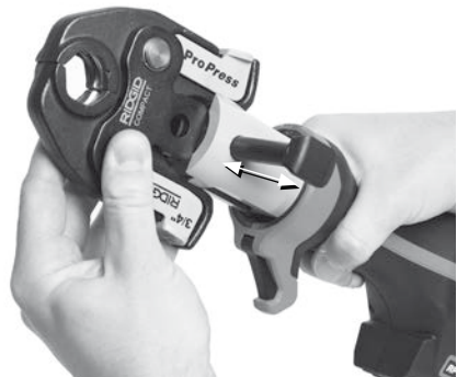
Figura 5 – Cavilha de montagem do acessório
