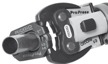
Bild 10 – Fästa aktuatoren på pressringen
