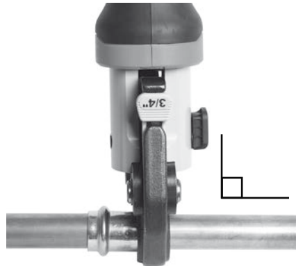
Şekil 8 – Çeneler Tespit Elemanına Dik
