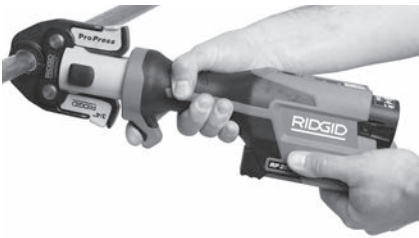
Figura 9 – Selladura del acoplamiento
