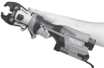
Slika 6 – Otvaranje čeljusti jednom rukom
