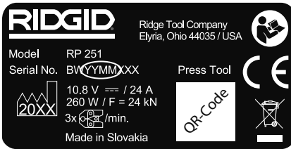
Kuva 2 – Koneen sarjanumero - Ympyröidyt numerot osoittavat valmistusvuoden ja -kuukauden. (YY = vuosi, MM = kuukausi, )
