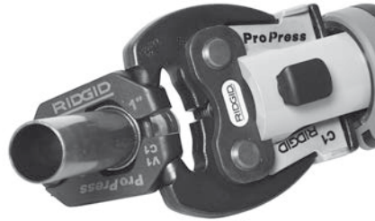
Figura 10 – Atașarea actuatorului la inelul de presare
