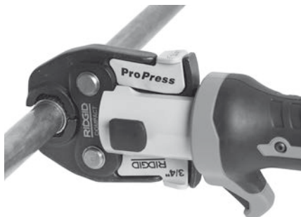
Εικόνα 7 - Τοποθέτηση σιαγόνων τύπου ψαλιδιού γύρω από τον σύνδεσμο
