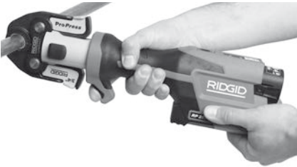
Şekil 9 – Tespit Elemanının Preslenmesi
