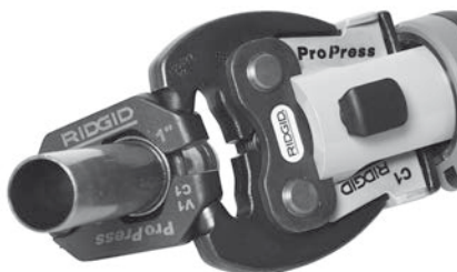
Rysunek 10 – Dołączanie siłownika do pierścienia zaciskowego
