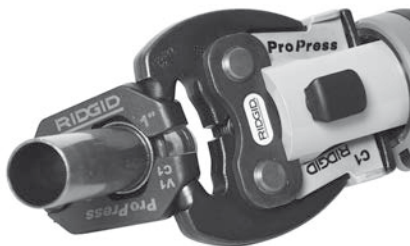
Slika 10 – Postavljanje aktuatora na prstenastu presu
