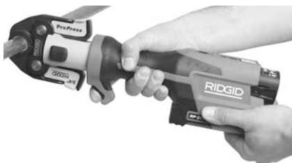
Εικόνα 9 - Πρεσαριστή σύσφιξη του εξαρτήματος σύνδεσης
