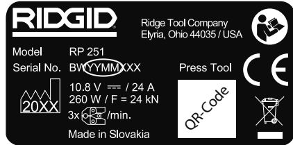
Figur 2 – Maskinserienummer – Tegnene, der er markeret med en cirkel, angiver produktionsåret og -måneden. (YY = år, MM = måned, )
