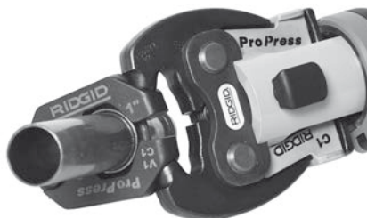
Figura 10 – Aggancio dell'attuatore all'anello di pressatura
