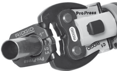
Рис. 10 – Крепление рабочей насадки на обжимном кольце
