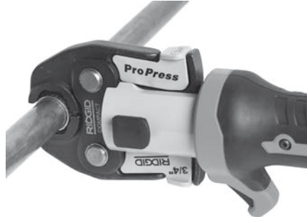
Bild 7 – Placera käftar av saxstil runt beslaget
