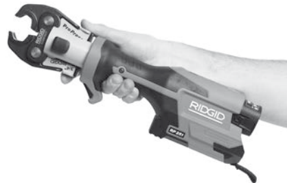
Abbildung 6 - Öffnen des Pressbackens mit einer Hand
