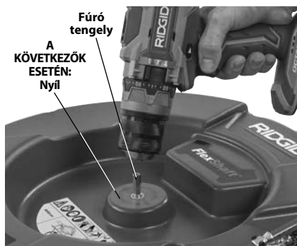
4. Ábra – A fúrógép csatlakoztatása a fúró tengelyhez
