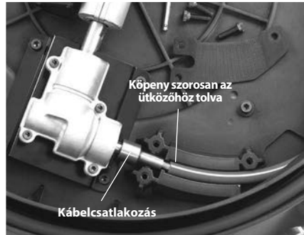
12. Ábra – A kábelszerelvény cseréje
