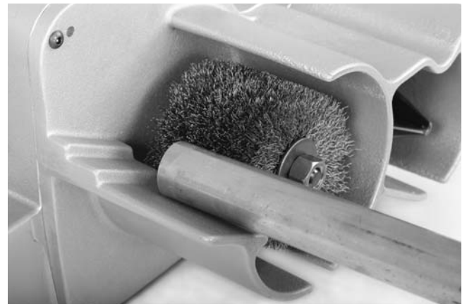
Figure 11 – Nettoyage externe du tube
