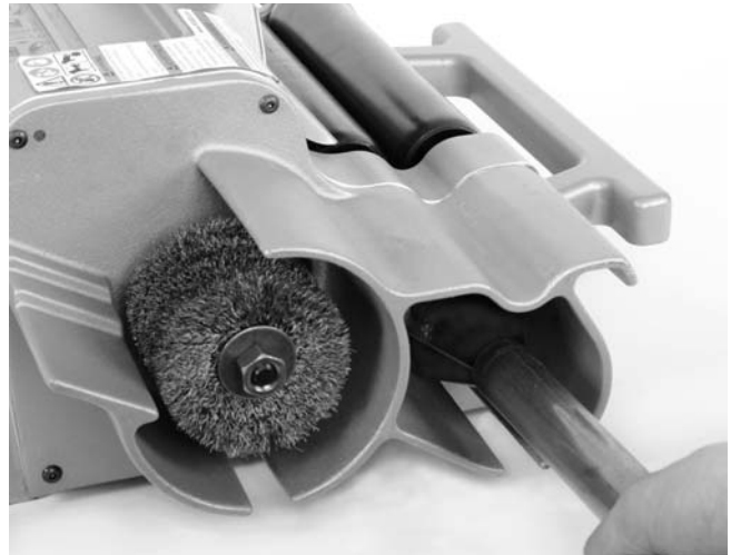
Figura 13 – Escariado del interior del tubo
