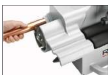
A nagy teljesítményű külső tisztítókefe gyorsan és könnyen tisztítja a 1/2" vagy 2" (12 - 54 mm) átmérőjű csövet
