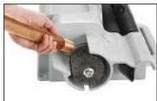
A választható sorjázó tárcsát a perem külső átmérőjének a sorjázására használható szoros illesztések segítségével
