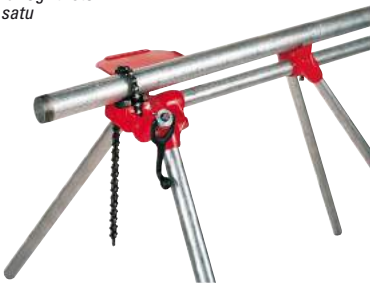
Csavaros feszítésű, állványra rögzíthető láncos satu
